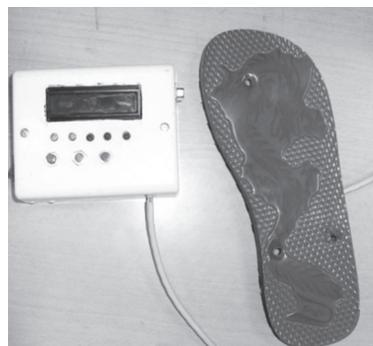
Прототип устройства для дозирования нагрузки в послеоперационном периоде
