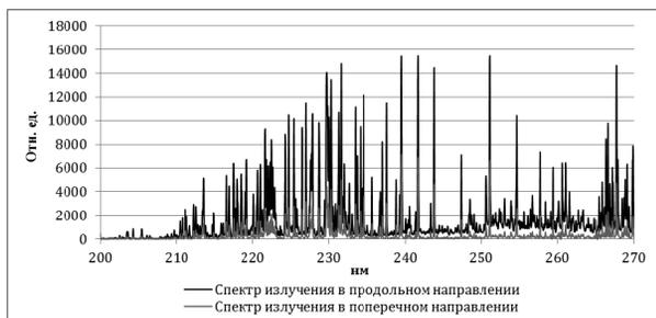
Рис. 4. Спектр излучения плазменного факела в ультрафиолетовой области; рабочее вещество – воздух + пары воды и бензина; 200–270 нм
