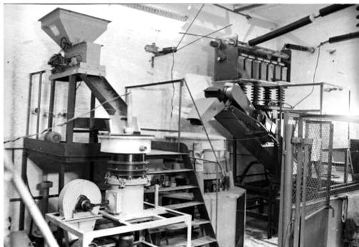
Рис. 5. Комплексная установка для дезинтеграции и выделения ограночного кристаллосырья (на испытательном стенде в КНИЦ РАН)
