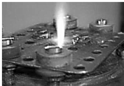
Рис. 1. а) Схема микроплазматрона; б) фотография плазменной струи в атмосферном воздухе: 1 – основной электрод, 2 – дополнительный электрод, 3 – кварцевая трубка, 4 – керамическая трубка, 5 – игла, 6 – канал для подачи воды, 7 – канал разряда, 8 – плазменная струя
