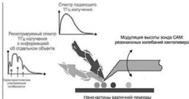
Рис. 4. Схема совмещения ТГц-спектроскопии с атомно-силовым микроскопом
