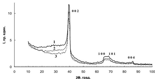
Рис. 10. Рентгеновские дифрактограммы аргоновой черни на разных этапах плазменной обработки:
