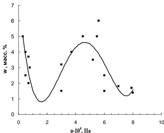
Рис. 2. Зависимость выхода фуллеренов  $w$  от давления аргона
