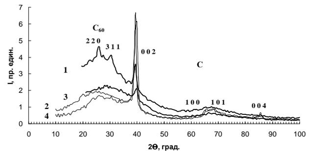
Рис. 4. Дифрактограммы сажи при  $p = 8 \cdot 10^3$  Па: 1 – от разряда в He, 2 – от разряда в Ar, 3 – после экстракции фуллеренов (He разряд), 4 – после экстракции фуллеренов (Ar разряд)
