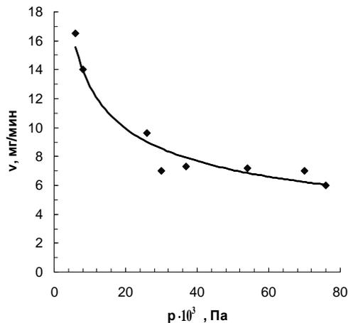
Рис. 1. Зависимость скорости образования сажи  $v$  от давления аргона
