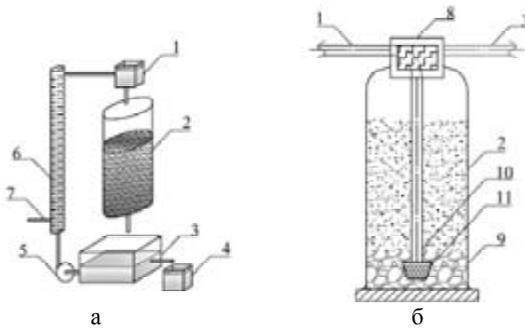
Рис. 1. Конструкции биосорбционных аппаратов: а – колонного типа, б – биосорбционный фильтр
