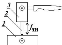
Рис. 8. Электроэрозионное упрочнение
