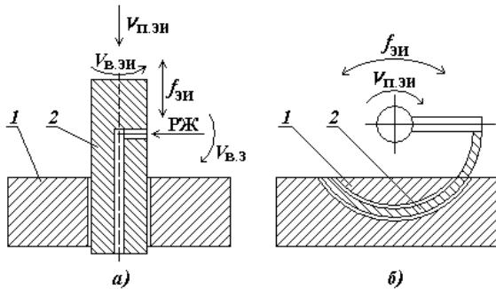
Рис. 5. Электроэррозионное прошивание
