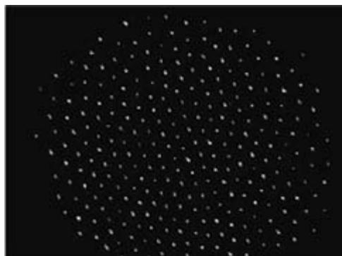
Рис. 1. Фотография горизонтального сечения середины плазменно-пылевой структуры
