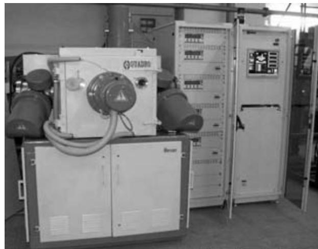
Рис. 3. Общий вид комплексной вакуумной ионно-плазменной установки «КВАДРО»
