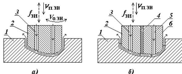
Рис. 6. Электроэррозионное объемное копирование
