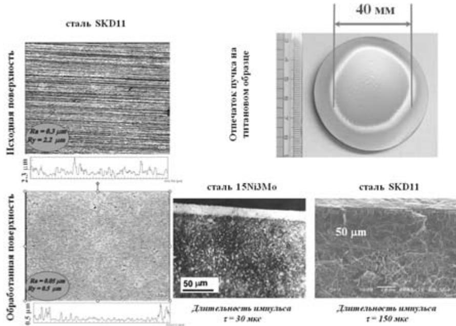
Рис. 10. Поверхность стали SKD11 до и после электронно-пучковой обработки, автограф электронного пучка  $\varnothing$  40 мм на титане, поперечные шлифы стали 15 Ni3Mo и SKD11 после обработки электронным пучком
