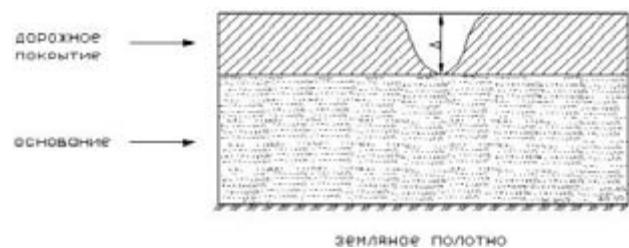
Рис. 1. Конструкция дорожной одежды лесовозной дороги
