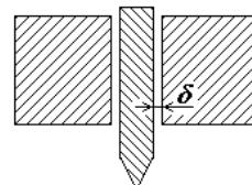
Рис. 9. Технологический зазор
