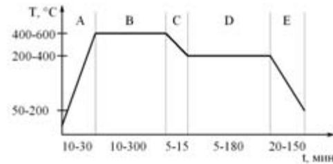
Рис. 5. Типовая температурно-временная диаграмма процесса обработки изделий
