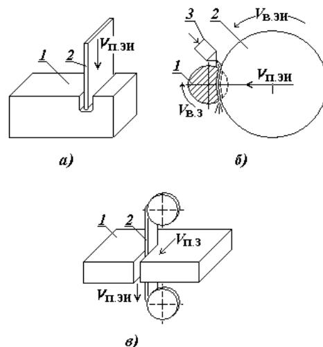
Рис. 3. Электроэррозионная отрезка
