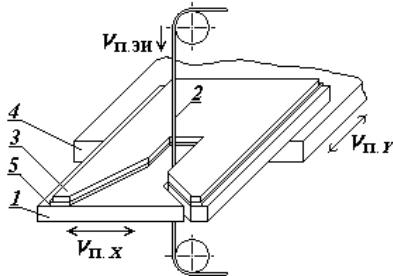
Рис. 4. Электроэррозионное вырезание
