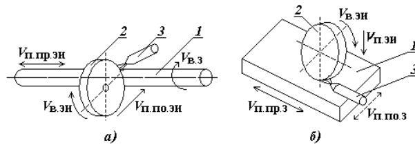
Рис. 7. Электроэррозионное шлифование:
